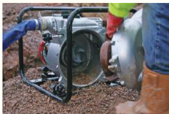
Eemaldatav hooldusluuk lubab kiiret ja hõlbust ligipääsu
